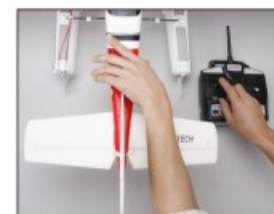
36. 通过调节水舵摇臂将水舵和方向舵调整到面平行。
