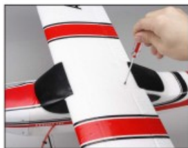
31. 用螺丝刀分别拧入两颗PM4*30MM螺丝。
