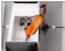
25. 将电调放入气球内, 用两根扎带扎紧。
