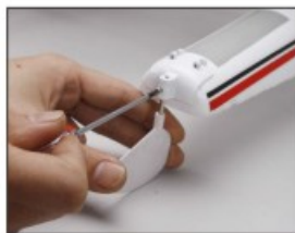
32. 如果你感觉飞机在水面转弯时迟钝，你可以将右水舵取消。这样飞机就可以有更好的灵活性。
